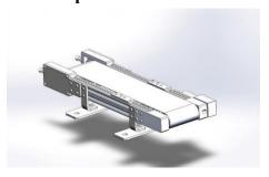
Конвейер содержит датчик наличия детали и датчик цвета для решения вопросов сортировки. Тип датчика — оптический, диффузный. Направляющие на конвейере позволяют настраивать расположение датчика.
